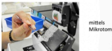
Ein Mikrotom ist ein Schneidegerät, mit dem man sehr dünne Schnittpräparate erstellen kann. Es dient zur Herstellung mikroskopischer Präparate, welche später durchstrahlt werden sollen.
